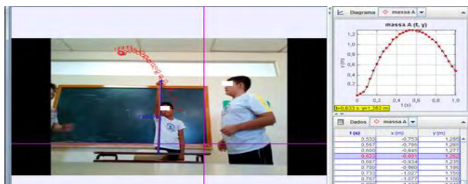
Figura 2 - Simulação da trajetória de queda livre. A parábola ao lado, obtida pelo Tracker, mostra o lançamento do foguete PET obtido pela equipe
